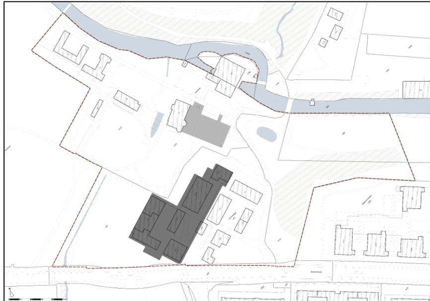
**Abb. 7:** Differenzplan Baubereiche für Tiefgaragen und Unterniveaubauten Hammer. Vergleich rechtskräftiger und überführter Bebauungsplan
