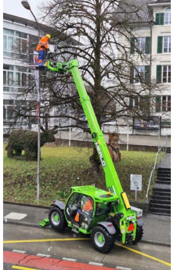
Einsatz Teleskopklader mit Korb zur Fahnen-Montage und -Demontage.
