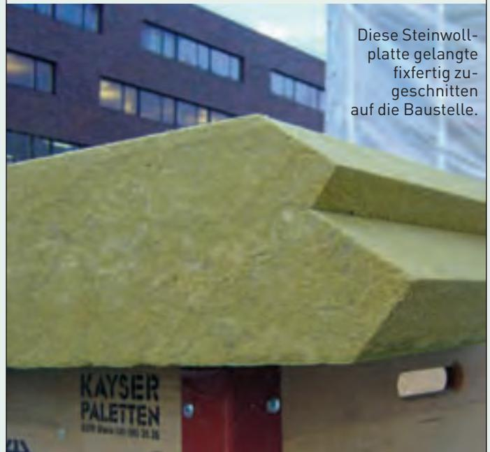
Diese Steinwollplatte gelangte fixfertig zugeschnitten auf die Baustelle.
