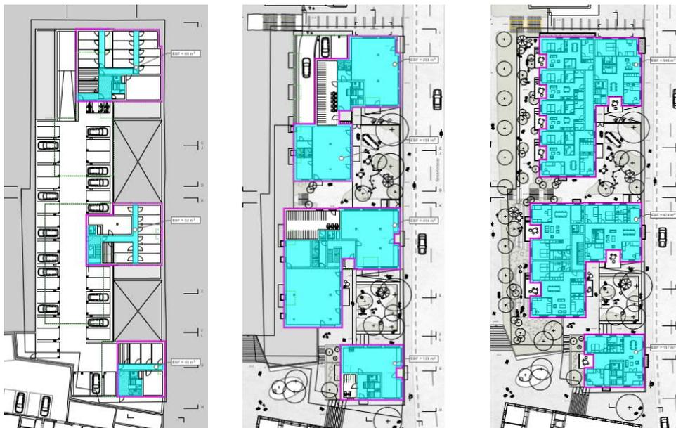
Abbildung 14 Energiebezugsfläche in **Blau** und thermische Gebäudehülle in **Pink**, von links nach rechts UG, EG, Regelgeschoss
