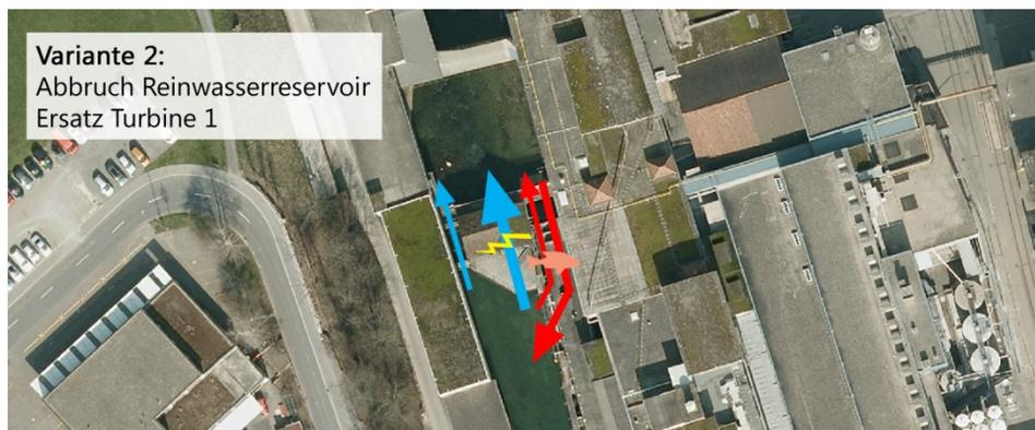
Abbildung 2: Übersicht Variante 2 (rot: Fischauf- und -abstieg, blau: Kraftwerk, Leerlaufschütz)
