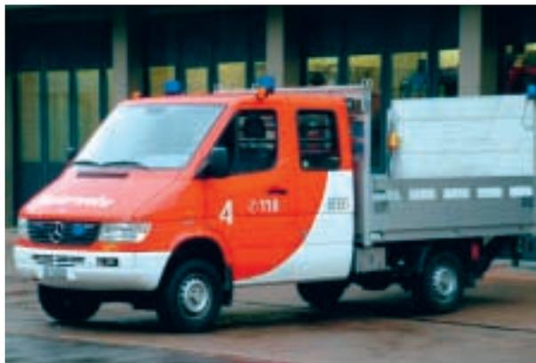
ken und stabilen hydraulischen Hebebühne ausgerüstet. Die Anhängerkupplung kann eine Anhängelast von 3 t aufnehmen. Das Fahrzeug wird mit den üblichen feuerwehrtechnischen Ausstattungen versehen und mit dem nötigen Zubehörmaterial ausgerüstet. Es entspricht den heutigen Sicherheits- und Umweltaanforderungen.
